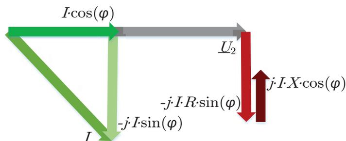
Abb. 4.2: Zeigerdiagramm zur Herleitung des Querspannungsabfalls
