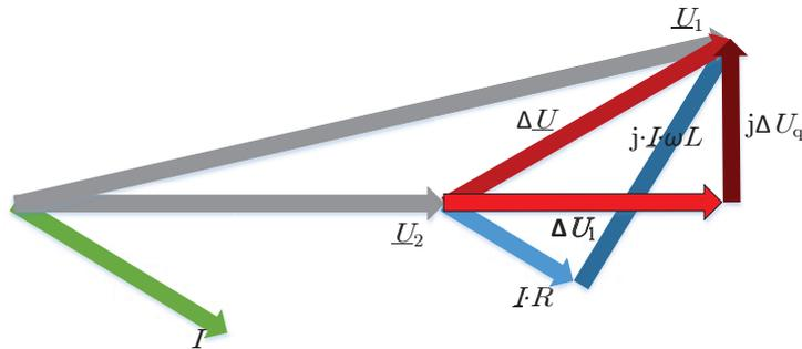
Abb. 4.1: Zeigerdiagramm zur Herleitung des Längsspannungsabfalls
